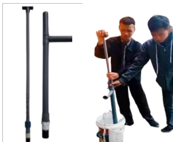
Gambar 10. Pompa Air di Uji Fungsi
