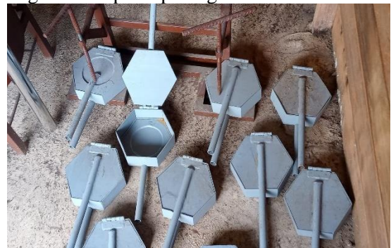
Gambar 3. a) Alat Pembakaran Sampah Plastik ramah asap b) alat cetakan dan alat press paving
